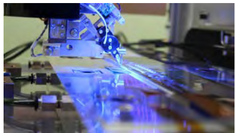
図 3. 半導体粒子検出器の試作の様子。微細な配線をワイヤボンディングでつなぐ。
