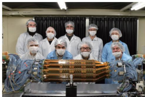
図 2. 当研究室で製作した、Belle II 測定装置の心臓部にあたる半導体粒子検出器。
