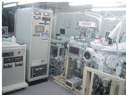
本研究室のクリーンルームに設置された超伝導 HEB ミクスア素子製造装置群
