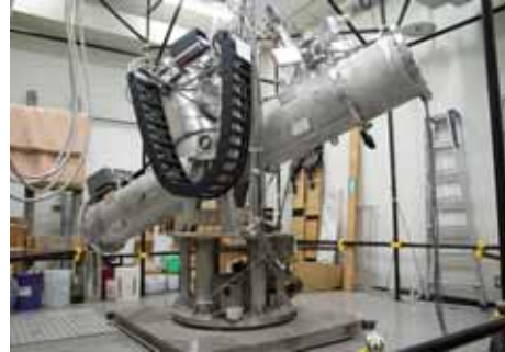
理学部一号館に設置されているアクシオンヘリオスコープ Sumico
