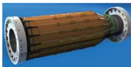
図 2. 当研究室で製作する、Belle II 測定装置心臓部の半導体粒子検出器の完成予想図。
