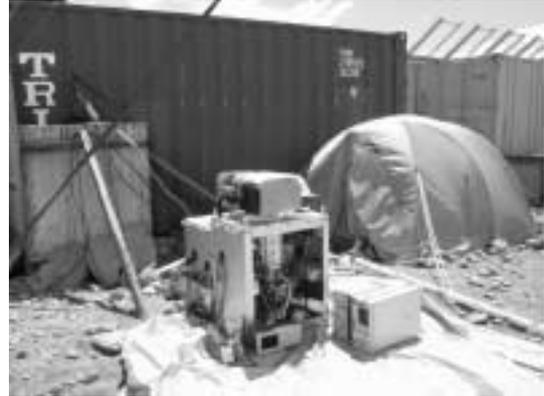
図 6.6 a: アタカマ高地パンパラボラでテスト運用中の可搬型 18cm サブミリ波望遠鏡
