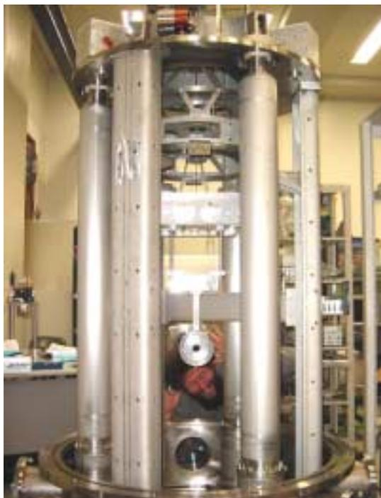
図 6.4 c: 3m プロトタイプ干渉計の真空槽に組み込まれた SAS。倒立振り子、2 台の GAS フィルター、鏡懸架装置からなる受動的防振装置を、倒立振り子上部に取り付けたセンサー、アクチュエータによって制御する。
