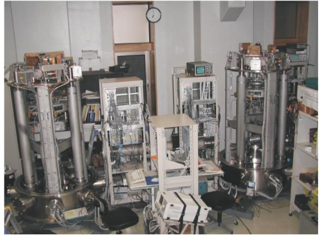
図 6.4 b: SAS を組み込んだ、3m Fabry-Perot 干渉計。干渉計の 2 枚の鏡は SAS によって防振される。
