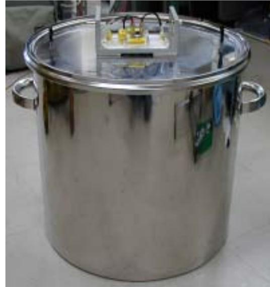
図 2.5 a: Radon gas monitor
