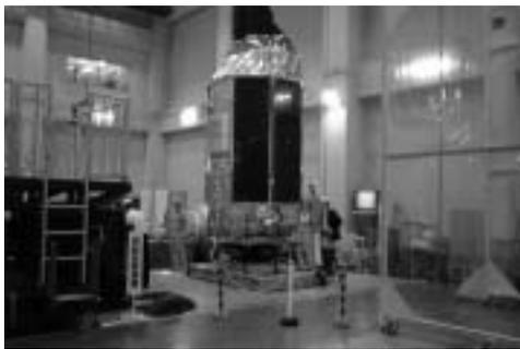
図 2.2 a: 衛星に組み込まれる HXD-S (上)。この中に、フォスフィスカウンター 16 本、アンタイカウンター 20 本が収納されている。下は振動試験中の Astro-E 衛星。
