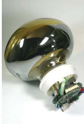
図 2.4.30: オールガラス製 8 インチ HPD 試作機
