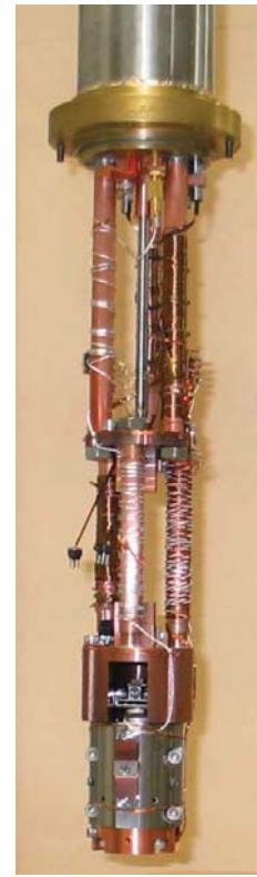
図 4.5.14: 半導体試料の剥離、金属原子の蒸着、走査型トンネル顕微鏡（最下部）を用いた剥離表面の観察、側面電極を用いたマクロな4端子測定、を *in situ* で行うためのセットアップ。断熱真空のためのステンレス管を取り付けた後、内径52 mmの超伝導磁石（液体ヘリウム温度）に挿入される。
