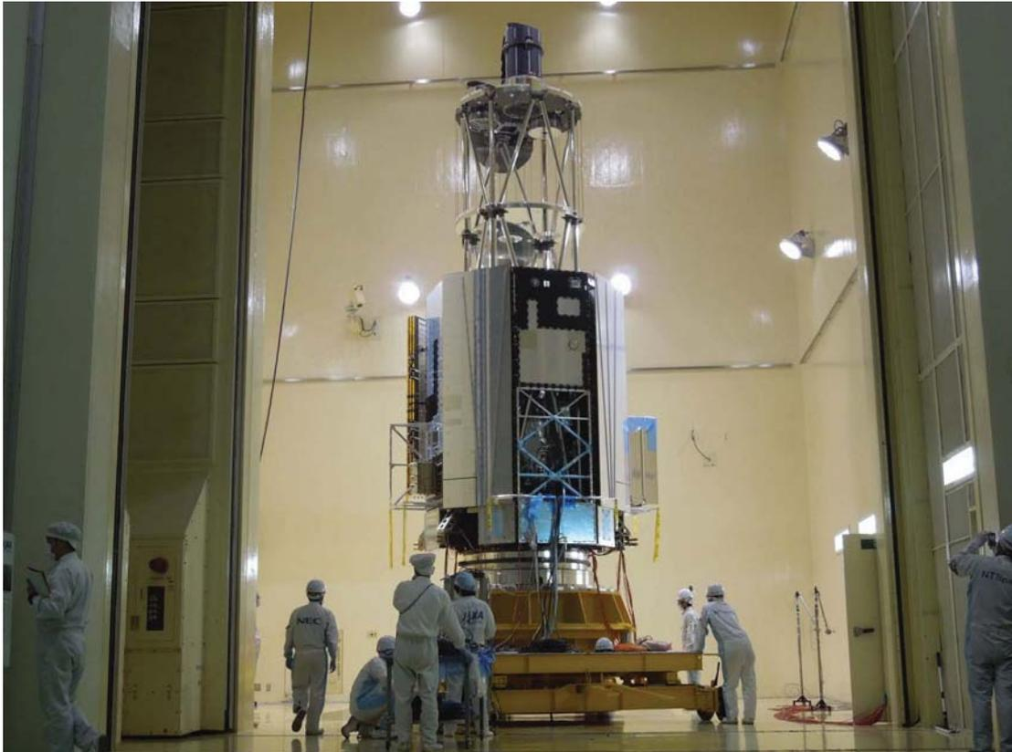
図 1: JAXA の音響試験設備に搬入される ASTRO-H 衛星。ロケットでの打ち上げ環境に耐えることを確認する試験の一コマ (写真は JAXA 提供)。ASTRO-H は日本の 6 代目の X 線観測衛星で、重さ 2.5 t、打ち上げ時の全長 8 m で、軌道上では 14 m に伸展する、日本で最大級の科学観測衛星である。最新の X 線検出器を複数搭載し、広い帯域を高感度で観測する力、X 線を精密に分光する力が、過去の衛星より桁違いに優れている。2015 年の打ち上げをめざし、JAXA を中心に東京大学はじめ国内の研究機関に加え、NASA、ESA などの世界の研究機関が協力して開発を進めている。(牧島・中澤研)
