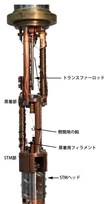
図 4.4.1: 走査トンネル分光顕微鏡と電子輸送特性の同時測定を行うための実験装置。
