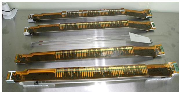
図 2.4.4: Belle II SVD ラダー生産組立手法を用いて組み立てた精密モックアップ
