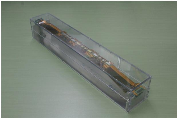
図 2.4.3: 本研究室を中心に製作した、Belle II SVD ラダーの一部読出し可能なプロトタイプモックアップ
