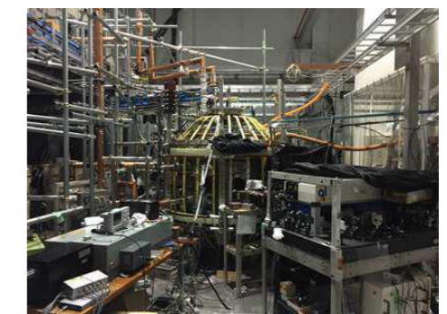
TST-2球状トカマク装置(柏キャンパス)。中央に見える真空容器の中に磁場で閉じ込められた高温プラズマが生成されます。
