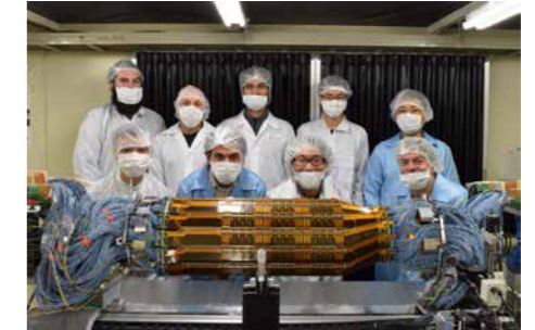
図 2. 当研究室で製作した、Belle II 測定装置の心臓部にあたる半導体粒子検出器。
