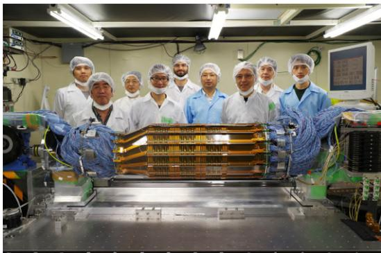
図 2.2.1: 本研究室が貢献した BelleII 実験 SVD 崩壊点検出器。最外層の 6 層目ラダーが見えている。
