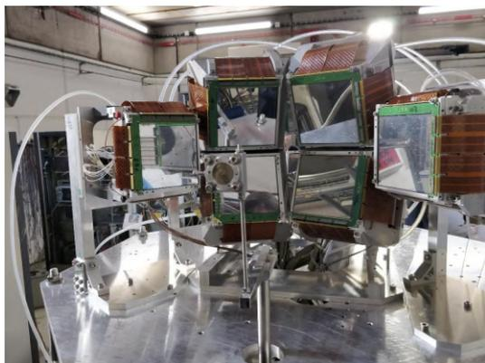
図 2.1.3: GANIL で使用した MUST2 検出器。MUST2 はストリップ型シリコン半導体検出器と CsI(Tl) 検出器で構成される反跳荷電粒子検出器で、本実験では全部で 8 台の MUST2 を使用した。
