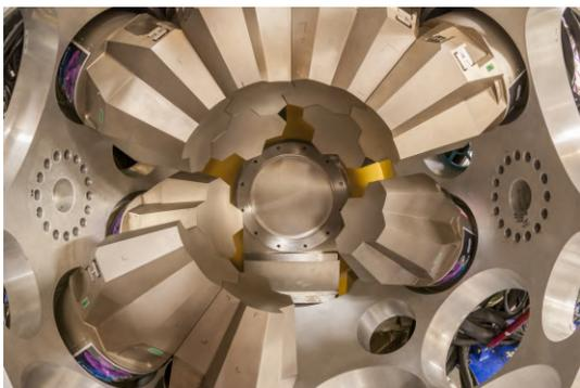
図 2.1.2: NSCL で使用したトラッキング型ガンマ線検出器アレイ GREINA。GREINA は全部で 32 台のゲルマニウム半導体結晶で構成される高分解能高効率ガンマ線検出器である。
