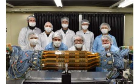
図 2. 当研究室で製作した、Belle II 測定装置の心臓部にあたる半導体粒子検出器。
