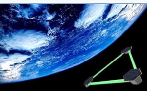
基線長100kmの宇宙重力波望遠鏡計画。低周波数帯に感度。連星合体の事前予測, 中間質量ブラックホールの観測など。
