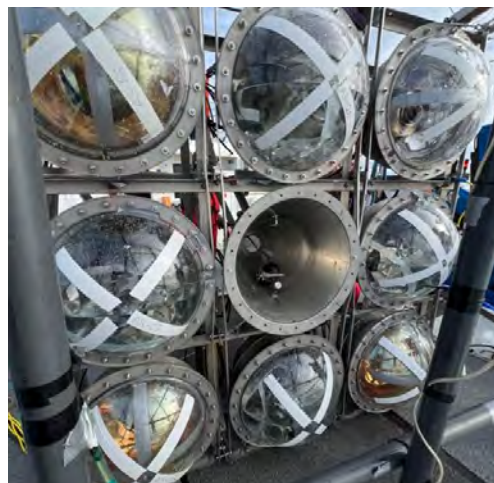
図 2.3.12: 50 cm 径光電子増倍管用カバーの試験の様子。
