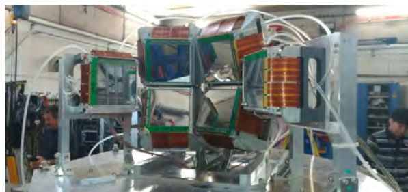
図 2.2.6: フランスの加速器施設 GANIL で行った実験で用いたシリコン半導体テレスコープ MUST2
