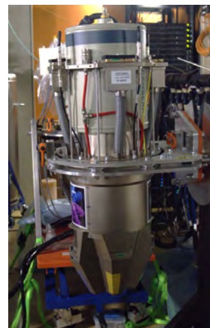
図 2.2.5: GT-5 プロジェクトにおいて性能評価試験中の三次元トラッキング型ゲルマニウム半導体検出器
