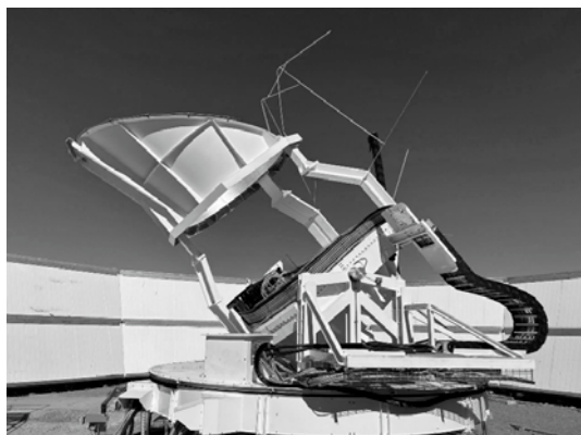
図 6.5.16: チリ観測所で建設中の Simons Observatory 4 台目小口径望遠鏡の様子。
