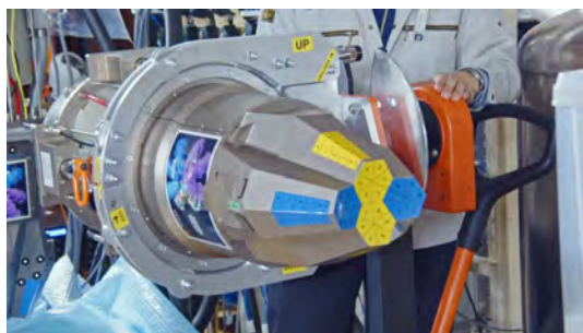
図 2.2.4: GT-5 プロジェクトにおいて性能評価試験中の三次元トラッキング型ゲルマニウム半導体検出器
