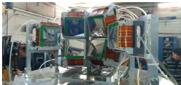
図 2.2.5: フランスの加速器施設 GANIL で行った実験で用いたシリコン半導体テレスコープ MUST2
